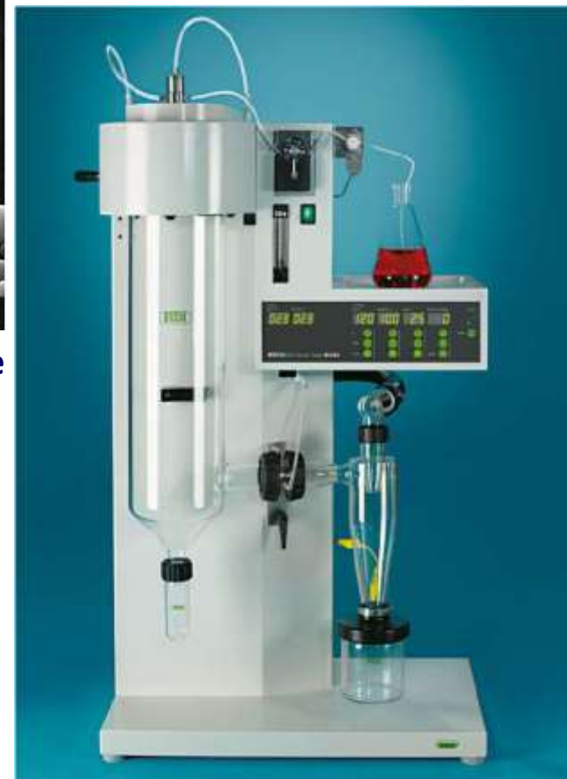
Suszarka rozpyłowa Büchi do wytwarzania mikrosfer zawierających leki
