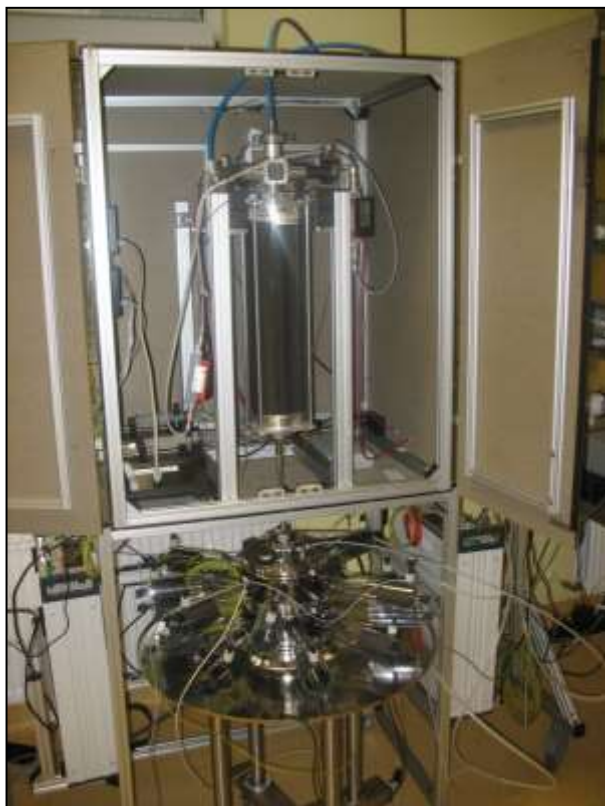
Przystawka do generowania zawiesiny nanomateriałów w powietrzu (TSE-Systems)
