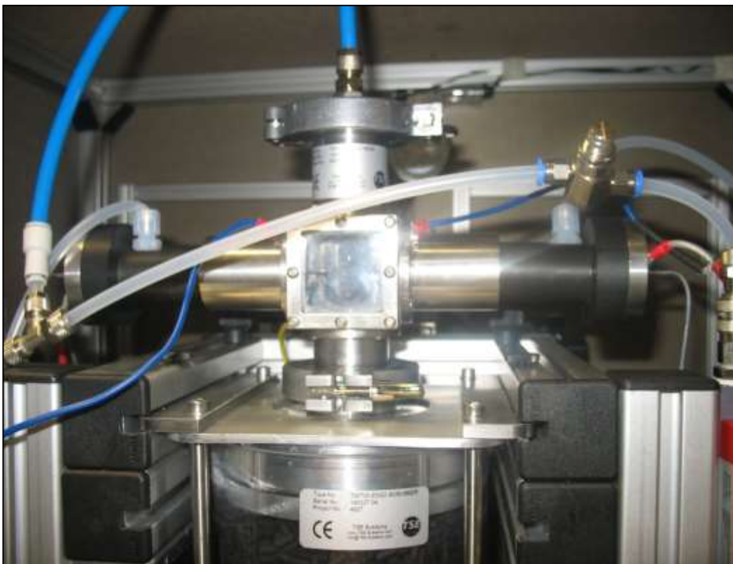
Przystawka do generowania zawiesiny nanomateriałów w powietrzu (TSE-Systems)
