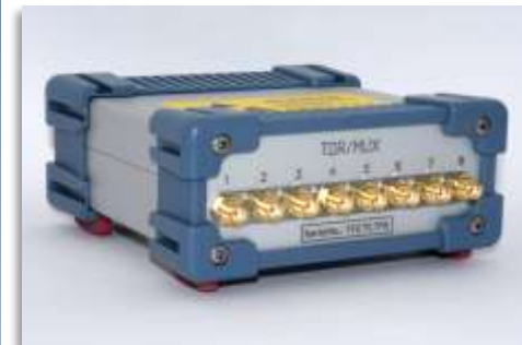
8-kanalowy laboratoryjny/polowy miernik TDR
